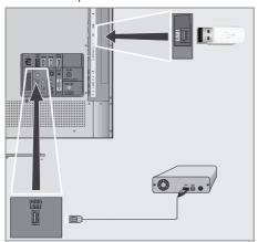
Buchse »USB2 (HDD)« des Fernsehgerätes und entsprechende Buchse des Datenträgers (externe Festplatte) mit einem USB-Kabel verbinden;
